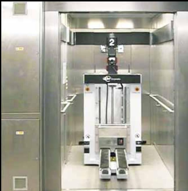
Axel hat eine intelligente Technologie entwickelt, die mit Robotersystemen interagiert und es den Robotern ermöglicht, die volle Kontrolle über den Aufzugsbetrieb zu übernehmen.
